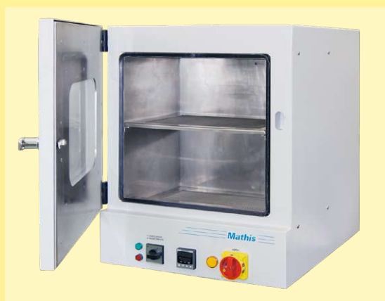
Estufa modelo FOR-B com bandeja para secar amostras (Para colocar perspirômetro PTE-B, remover a bandeja.)
